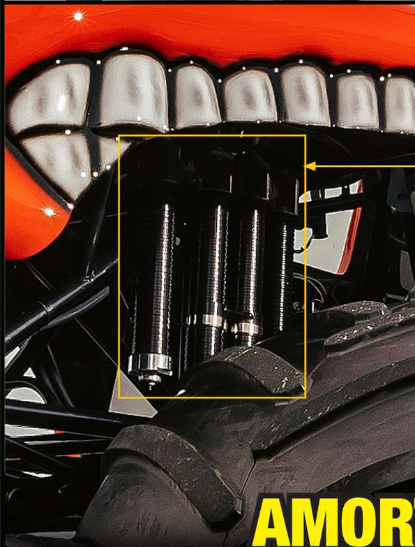
Les amortisseurs sont une des pièces les plus importantes des camions **Monster Jam®** et, combinés à d'autres dispositifs de sécurité, ils permettent aux athlètes de Monster Jam de réaliser des cascades d'envergure mondiale !
